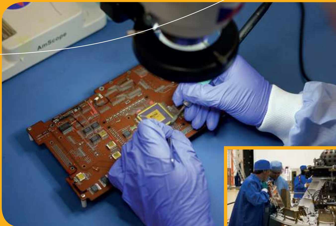
Velká fotografie – Modifikace COFP 256. Zdroj: G.L. Electronic. Malá fotografie – Montáž na adaptéru družice Lares. Zdroj: ESA
